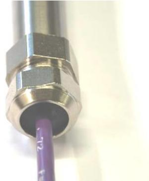
Abbildung 15: Gummiquetschdichtung Minikabel 72 Fs
