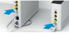
Pour cela, utilisez le câble Ethernet fourni ou raccordez la WLAN-Box 2 à votre câblage domestique. Les connexions câblées entre l'Internet-Box et la WLAN-Box 2 garantissent un WLAN optimal pour vos appareils. Vous pouvez également connecter votre WLAN-Box 2 par WLAN comme indiqué (à l'étape 5b).
