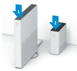
Marche à suivre: appuyez sur les 2 touches+ (Internet-Box et WLAN-Box 2) d'ici 2 minutes pour coupler automatiquement les 2 appareils
