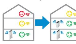
La WLAN-Box 2 peut être raccordée directement par WLAN installez la WLAN-Box 2 à mi-chemin entre votre Internet-Box et un lieu sans WLAN. Lisez attentivement les conseils dans «Configurer la WLAN-Box» 2 au verso.
