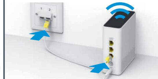
**Remarque:** l'armoire de distribution peut fortement affaiblir la réception WLAN et DECT. Pour améliorer la puissance du WLAN, il est recommandé de brancher une WLAN-Box 2 dans une pièce centrale. Pour en savoir plus sur la WLAN-Box: [swisscom.ch/wlan-box2](http://swisscom.ch/wlan-box2)
