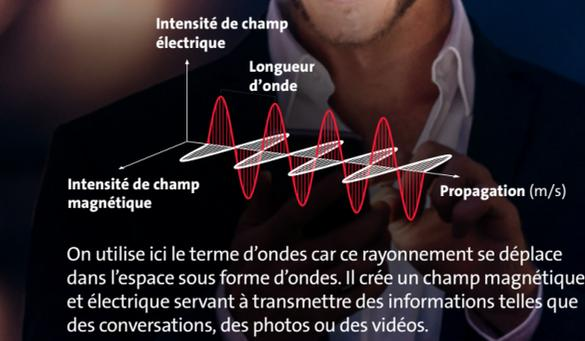
La **longueur d'onde** décrit la distance à laquelle une onde se propage pendant une oscillation. Des longueurs d'onde plus courtes signifient une fréquence plus élevée.
